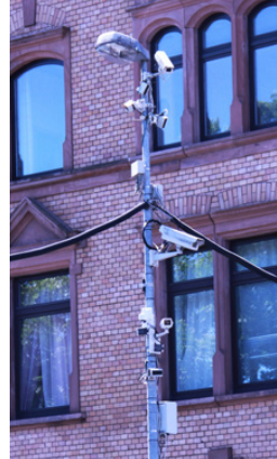
Abb. 2ab: Die Forschungskreuzung an der TH Aschaffenburg ist mit umfangreicher Sensorik ausgestattet. Differential GPS, Radar, Lidar und Stereokameras ermöglichen ein hochgenaues Tracking der Fußgänger und der Fahrzeuge. (Quelle THAB)
