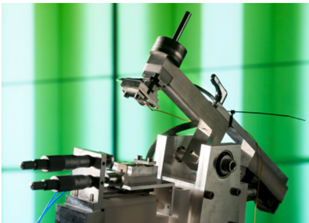
Reibkorrosionsprüfstand des Fraunhofer EMFT zur Modellierung von Schadensmechanismen an kommerziellen Stecksystemen. Quelle: Fraunhofer EMFT / Bernd Müller
