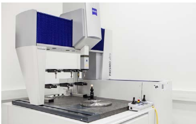
Hochgenaues 3D-Koordinaten-Mess-System ZEISS Prismo Ultra im akkreditierten Feinmeßraum. (Quelle: Q-Tech Roding)
