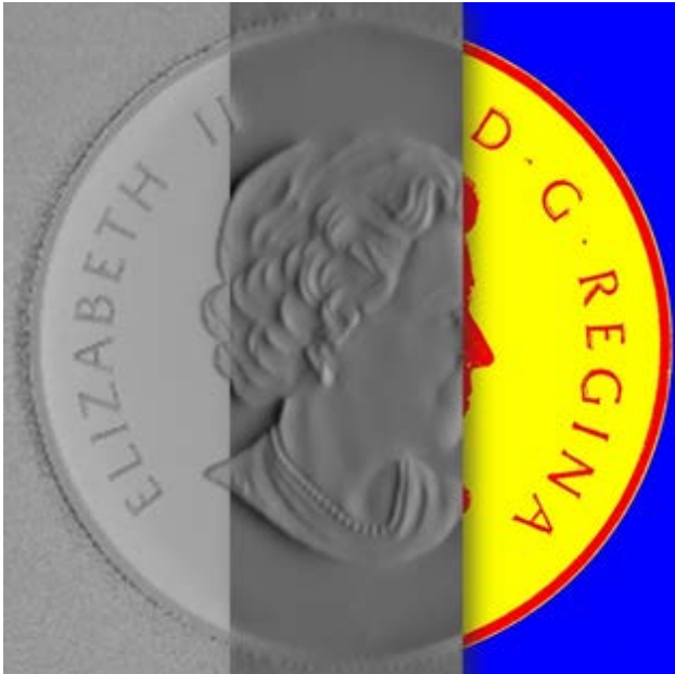
Inline Computational Imaging – simultane Inspektion von 2D und 3D Merkmalen am bewegten Prüfobjekt mit nur einer Kamera. (Quelle: AIT)
