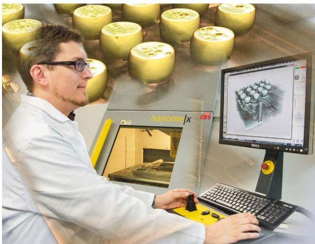
Für vergossene oder verkapselte Baugruppen ist die CT-Messung laut RoodMicrotec Experten Björn Hofmann besonders vorteilhaft. Quelle: RoodMicrotec
