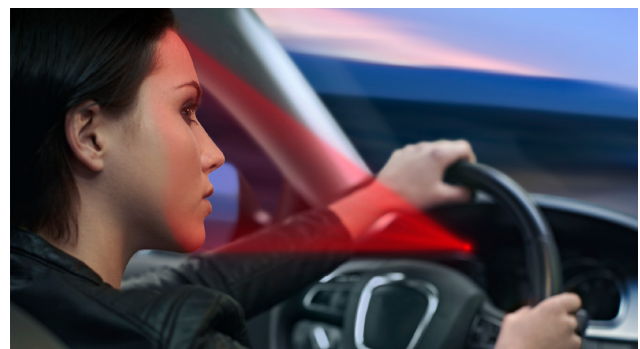
Infrarot-LEDs beleuchten das Gesicht des Fahrers beim „Driver Monitoring“. Quelle: OSRAM
